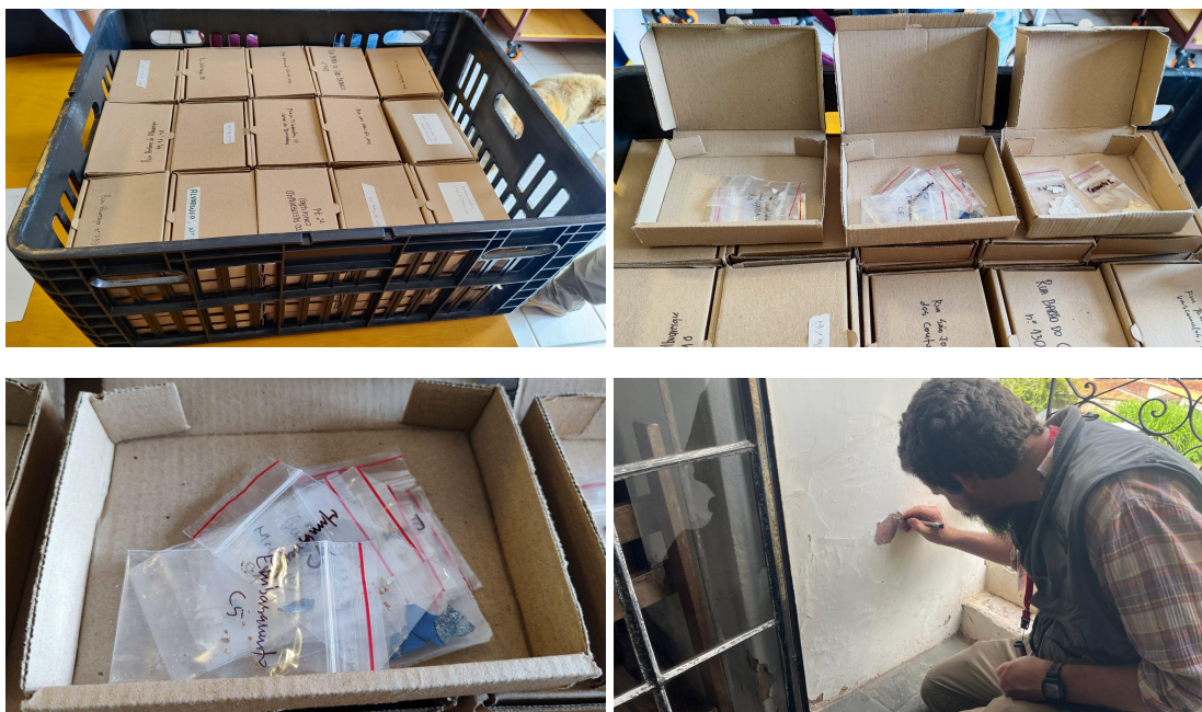
Fragmentos de camadas pictóricas extraídos do casario de Ouro Preto para análise e catalogação
